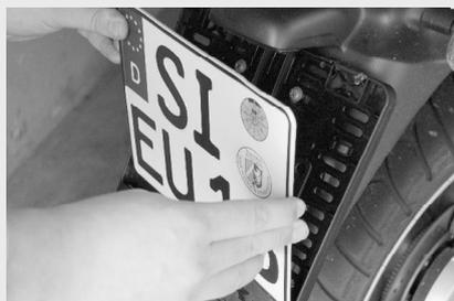
3.) Klippen Sie nun den oberen Rand des Kennzeichens in die zwei Haltenasen (oben / rechts und links) bis das Kennzeichen fest eingerastet ist.
