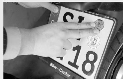
5.) Die Demontage erfolgt in umgekehrter Reihenfolge: Drücken Sie die beiden Haltenasen etwas zurück, so dass der obere Rand des Kennzeichens hervorsteht. Entnehmen Sie nun das Kennzeichen aus dem Rahmen.
