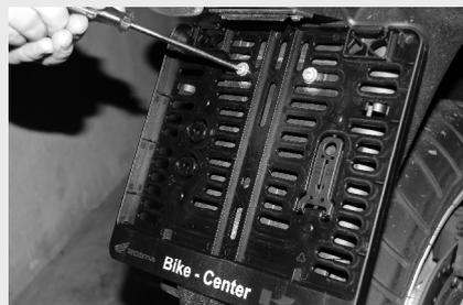
1.) Wählen Sie das passende Lochbild und befestigen Sie den Kennzeichenrahmen mit den geeigneten Schrauben.
