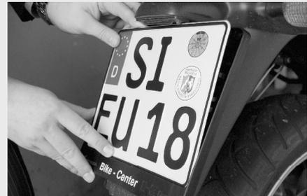
2.) Setzen Sie das Kennzeichen von oben in den unteren Spalt des Rahmens ein.
